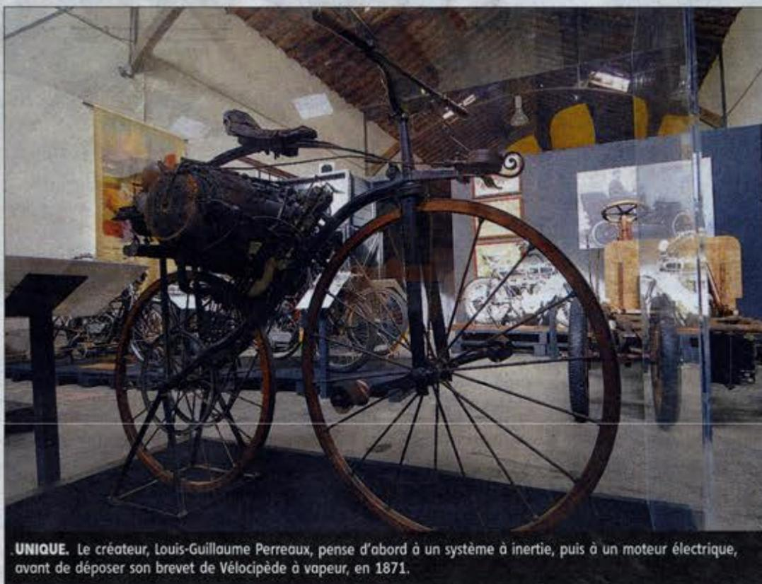
UNIQUE. Le créateur, Louis-Guillaume Perreaux, pense d'abord à un système à inertie, puis à un moteur électrique, avant de déposer son brevet de Vélocipède à vapeur, en 1871.
