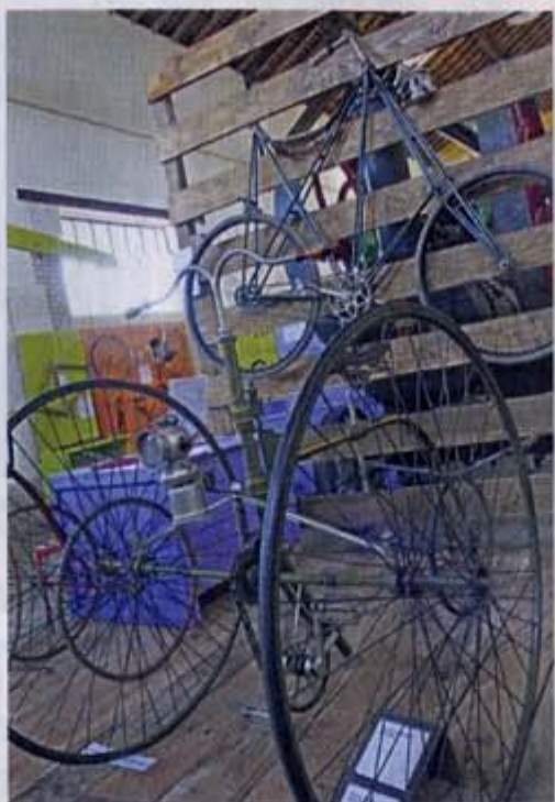
▲ Anzani sert de "fil conducteur" à l'expo, comme sur cet incroyable panachage entre un bas-moteur Anzani greffé d'un ensemble cylindre-culasse 250 cm 3 provenant d'un twin GN Salmson qui équipait des voitures de course en 1921.
